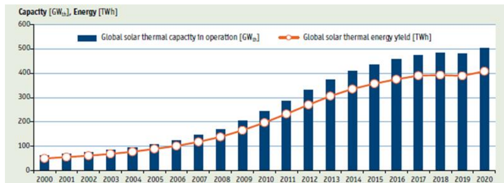
Figura 3 Capacidad termosolar global en funcionamiento y energía anual 2000-2020 (IEA, [3])
