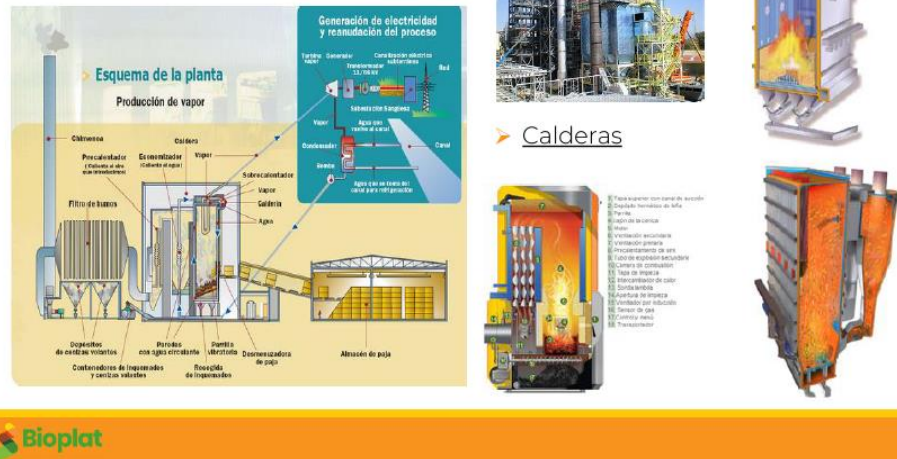
Figura 4. Esquema ejemplo de planta de producción de electricidad por COMBUSTIÓN directa de biomasa (fuente: BIOPLAT)
