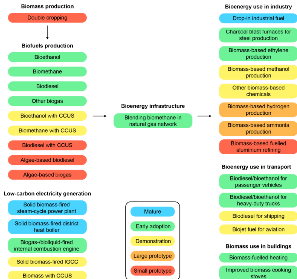
Figura 26. Nivel de preparación tecnológica de las tecnologías a lo largo de la cadena de valor de la bioenergía (Fuente IEA, 2020, [27]).
